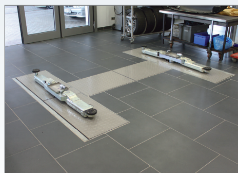
Когда крышки закрыты, а подъемник на поверхности пола, он может быть использован по назначению
