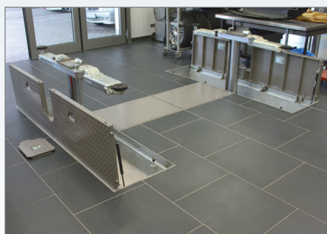
Рамная система с закрывающимися пластинами полностью гальванизирована
