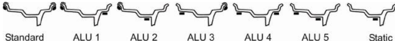
Рисунок 6.2 – Схемы установки грузов
