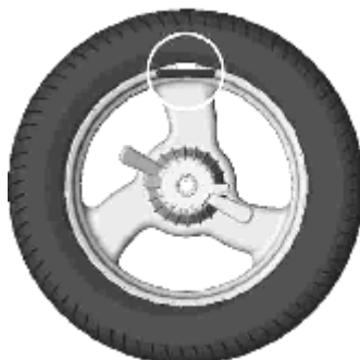
Рисунок 7.5 – Груз установлен в положение «12 часов»
