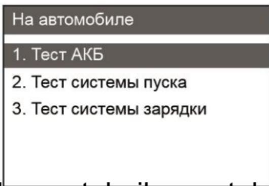
Теперь тестер обнаруживает, что поверхностный заряд устранен. Выключите свет фар, затем нажмите кнопку **ВВОД**, тестер производит автоматическое тестирование АКБ.
