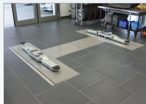
Когда крышки закрыты, а подъемник на поверхности пола, он может быть использован по назначению
