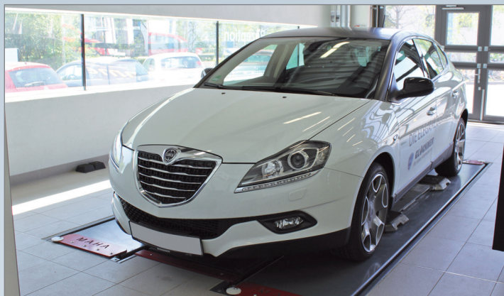
Подъемник опущен. Монтаж вровень с полом обеспечивает легкий проезд по подъемнику даже автомобилям с малым дорожным просветом.
