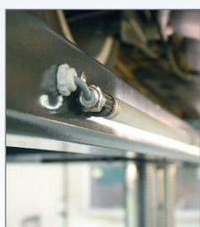
Поворотные светодиодные лампы: простая и быстрая настройка направления освещения, без ослепления находящихся под автомобилем людей.
