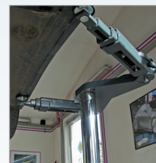
Телескопические рычаги с большой областью подхвата.
