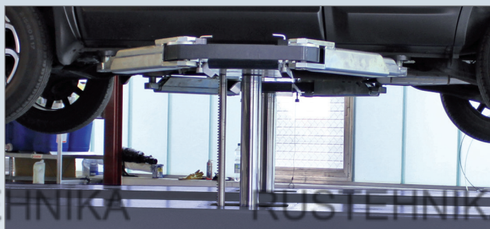
Платформенный подъемник с подъемником второго уровня с телескопическими рычагами, грузоподъемность 3,2 т; 3,5 т или 5,0 т
