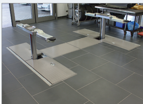
Рамная система с закрывающимися пластинами полностью гальванизирована
