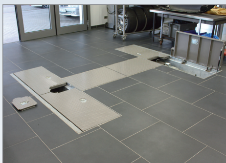
Система с пневмоамортизаторами обеспечивает легкое открывание и закрывание крышек.
