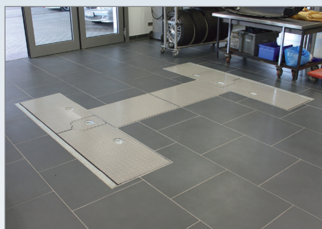
Рычаги целиком закрыты специальными крышками. Имеют проездную нагрузку 2 т.
