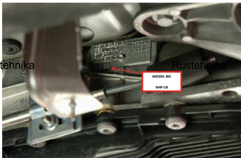
Рис 7 – Пример расположения идентификационной таблички АКПП
