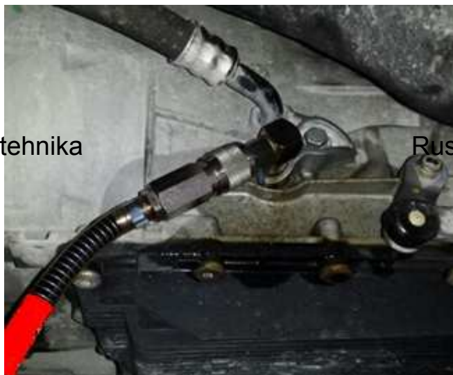
Рис 11 – Подключение установки к автомобилю
