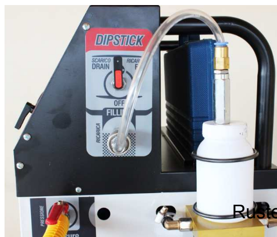
Рис 13 – Подключение бачка для аддитива
