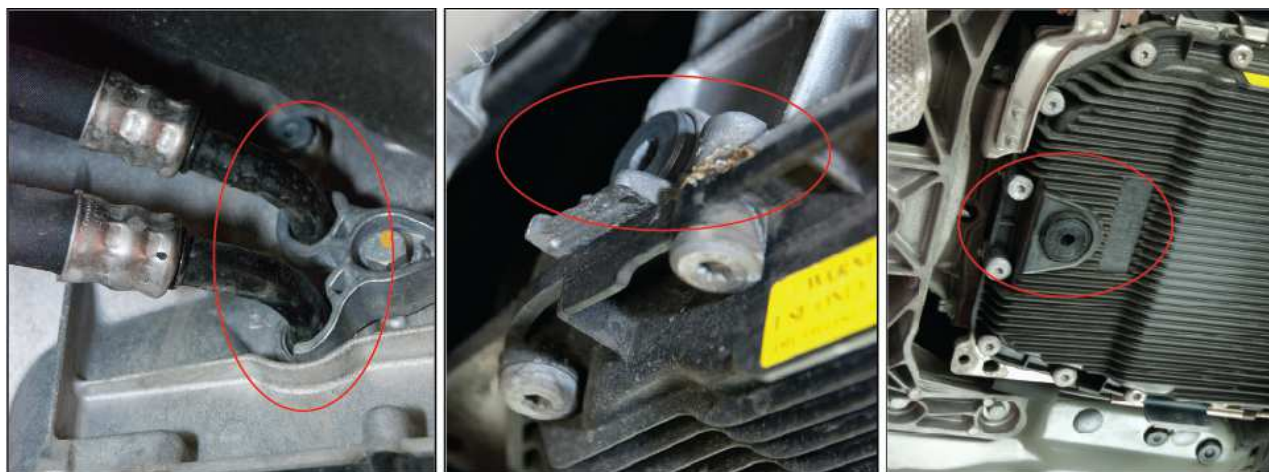
Рис 8 - Трубки подачи и слива, индикатор уровня, сливная пробка
