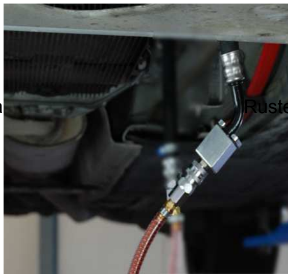
Рис 12 – Подключение установки к автомобилю
