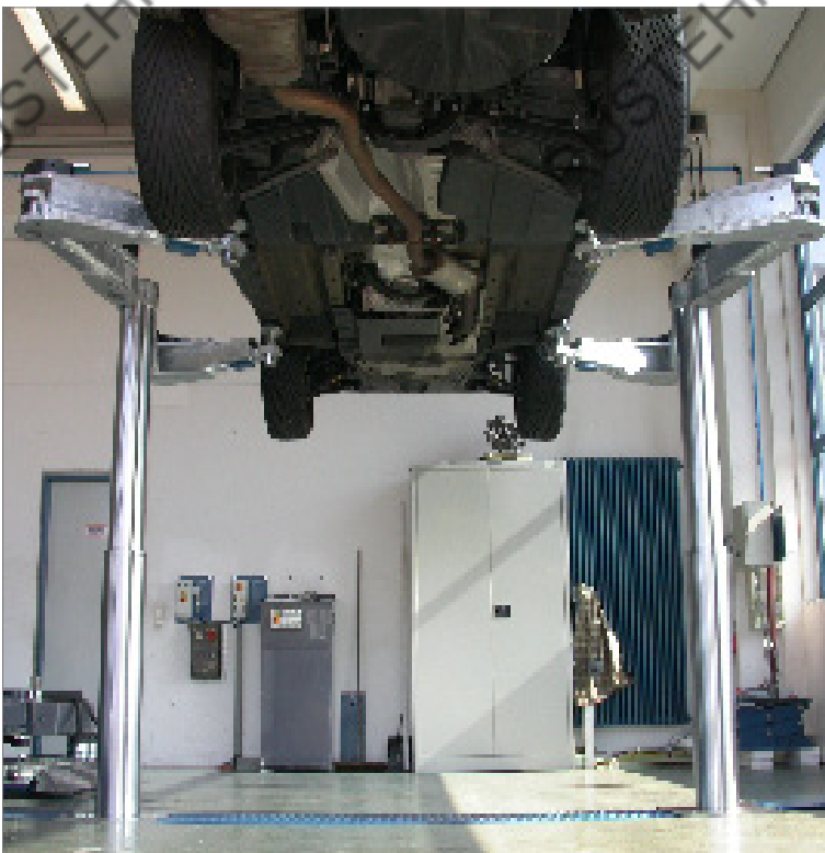
2.50 TTKAS с двухшарнирными захватами, грузоподъемность 5 т
