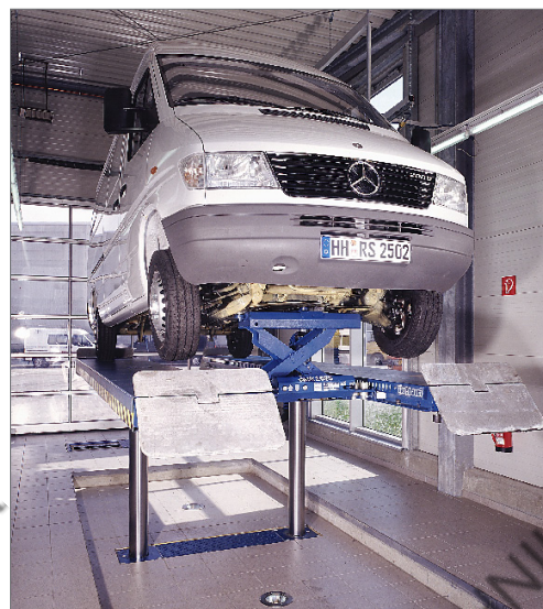
2.50 ТТА с длинными платформами и осеподъемником
