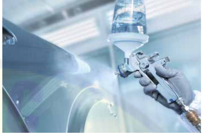
"Мягкий" факел – SATAjet 4000 B отлично подходит для окраски деталей сложной формы.
