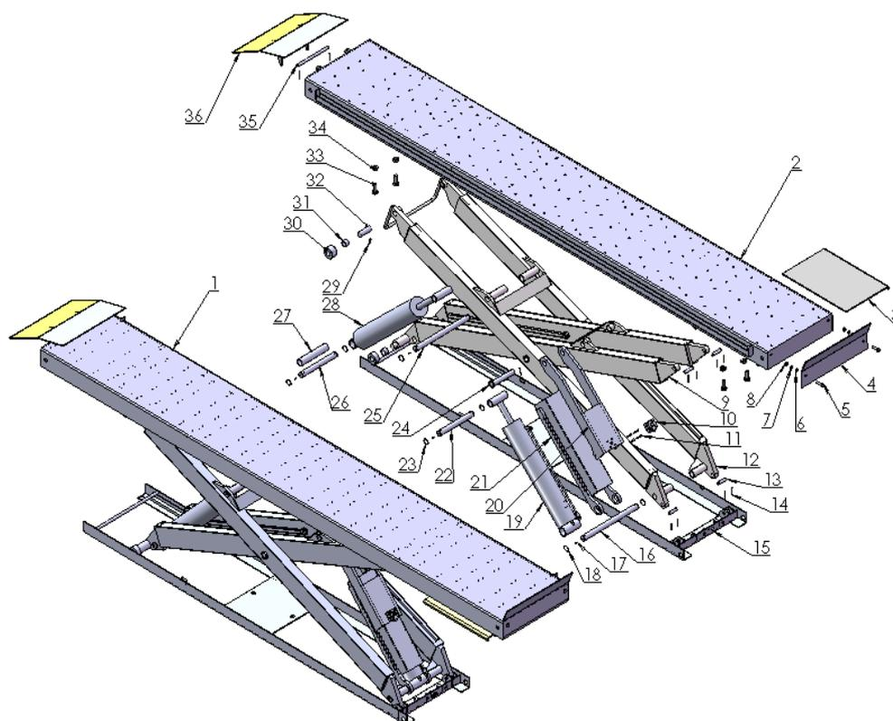
Детализовка Модель X400/ X500 (Рис.6)
