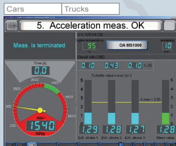
Дизельный тест Ясное отображение результатов измерения дизельного двигателя
