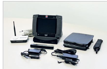
Переносной Touchscreen FTS с радиоканалом управления
