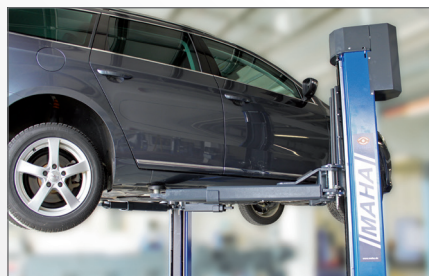
Комфортные условия работы благодаря большой высоте подъема (2000 мм).
