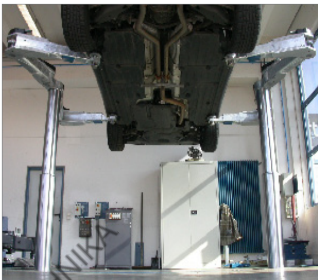
2.50 TTK с двухшарнирными захватами
