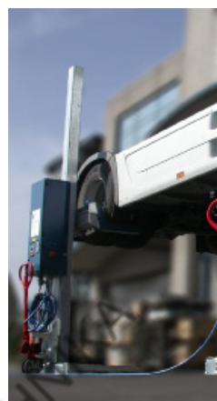
регулируемые вилочные захваты для колес от 12" до 22" с фиксатором
