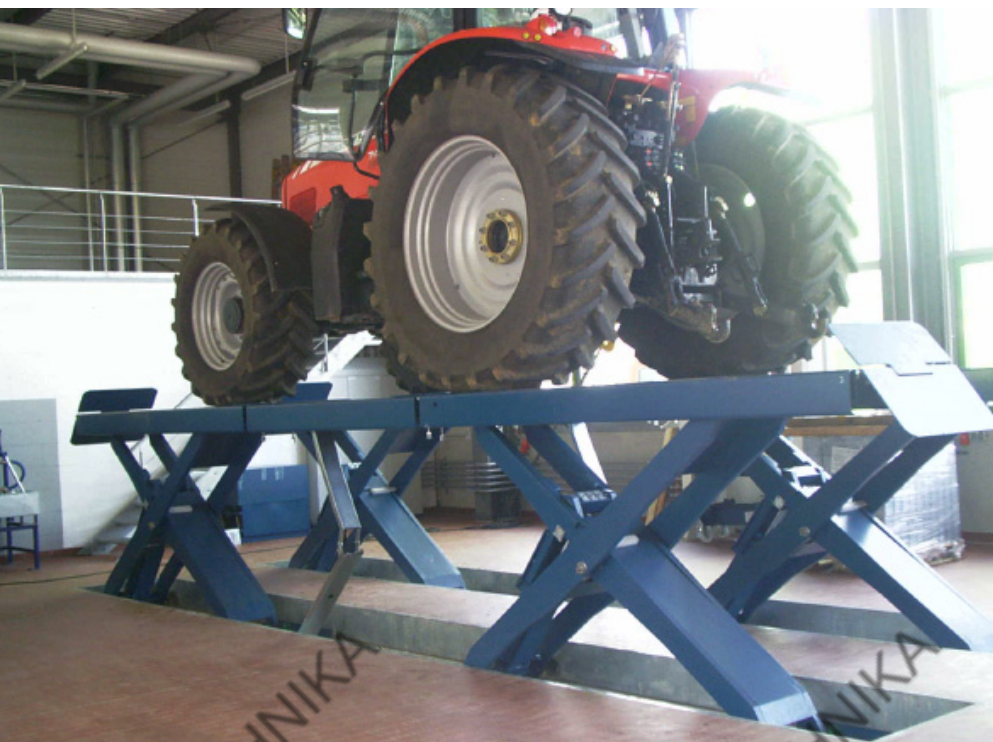
Модули подъемника могут управляться по отдельности.
